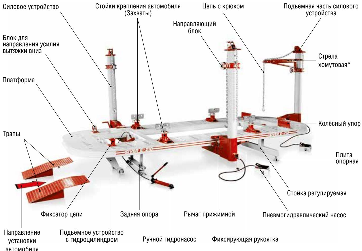
\*Дополнительное силовое устройство, стрела хомутовая, ручной гидравлический насос являются опциями и поставляются отдельно.
