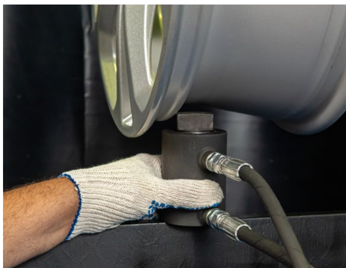
При повреждении от наружной к внутренней стороне обода
